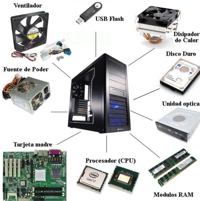
**Fuente de poder:** Reduce la corriente eléctrica de 120V y 220V a voltajes más bajos, para alimentar los elementos que conforman una computadora. Algunas de estas fuentes protegen la computadora de altos voltajes y apagones repentinos.
